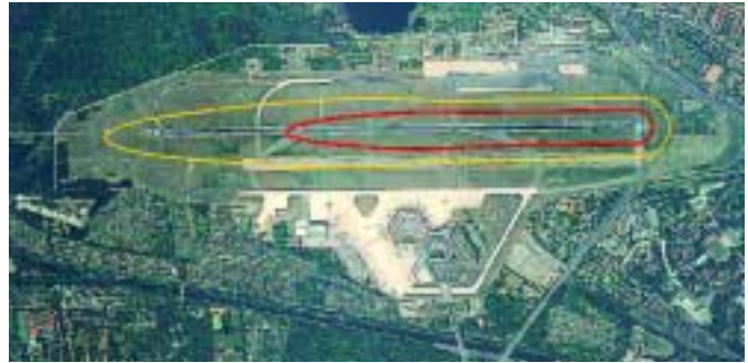
Lärmteppiche des Canadair Jet 100/200 (rote Linie) und des Avro RJ85 (gelbe Linie) beim Start auf dem Flughafen Tegel. Der Lärm bleibt auf das Flughafengelände beschränkt.
